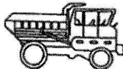
Самосвал с вращающимся сиденьем и двумя комплектами средств управления
